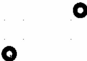
Dans cette situation, lorsque l'option '*Verrouillage angle de piste*' est validée, le fait de cliquer sur une pastille permettra d'obtenir l'angle souhaité tout en offrant la connexion désirée. Le résultat est une connexion ordonnée montrée ci-dessous.
